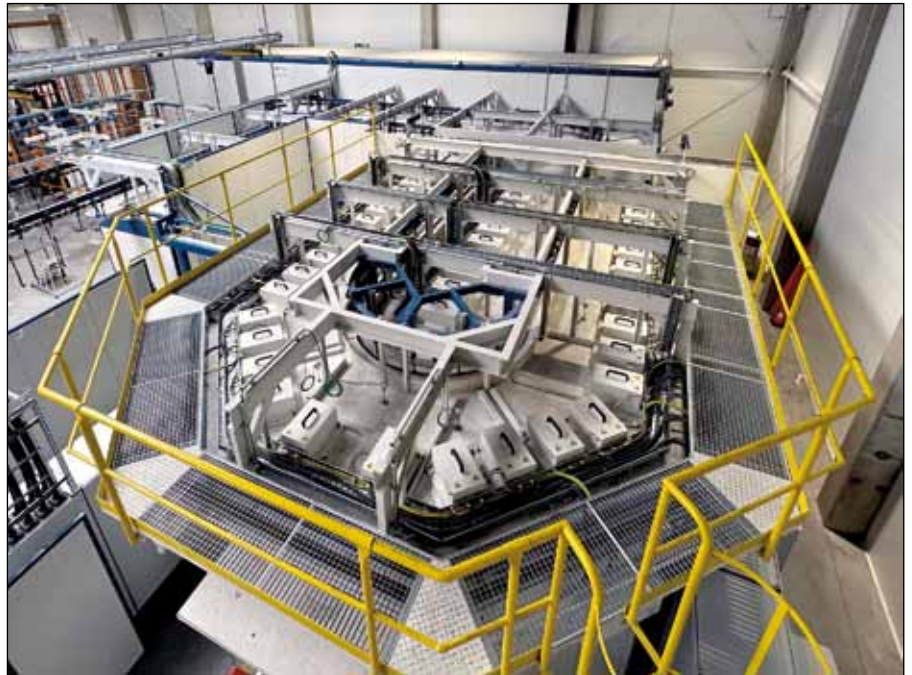
Abbildung 2: Elektrischer Takt-Umkehrmaillierofen für die Boilerproduktion
