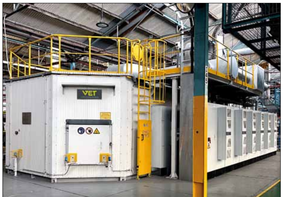
Abbildung 1: Elektrischer Emaillierofen für die Backkastenproduktion
